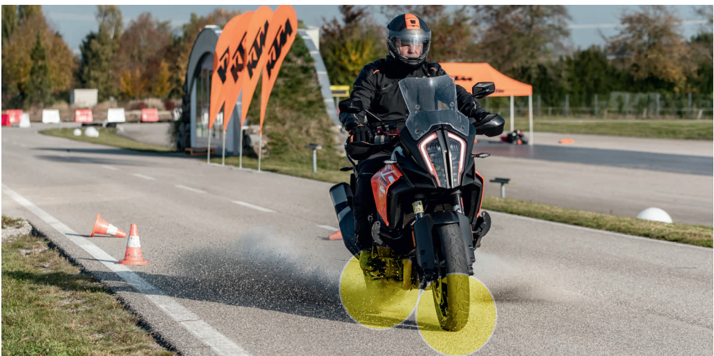
Abb. 150: Bremsen ohne ABS - Blockierendes Hinter- und Vorderrad
